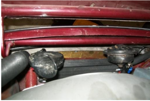
Radiateur vu de l'arrière : Noter les trous percés dans la jupe avec grille
