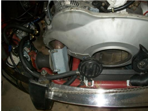
ensemble : noter la tôle de protection thermique sur l'échappement
